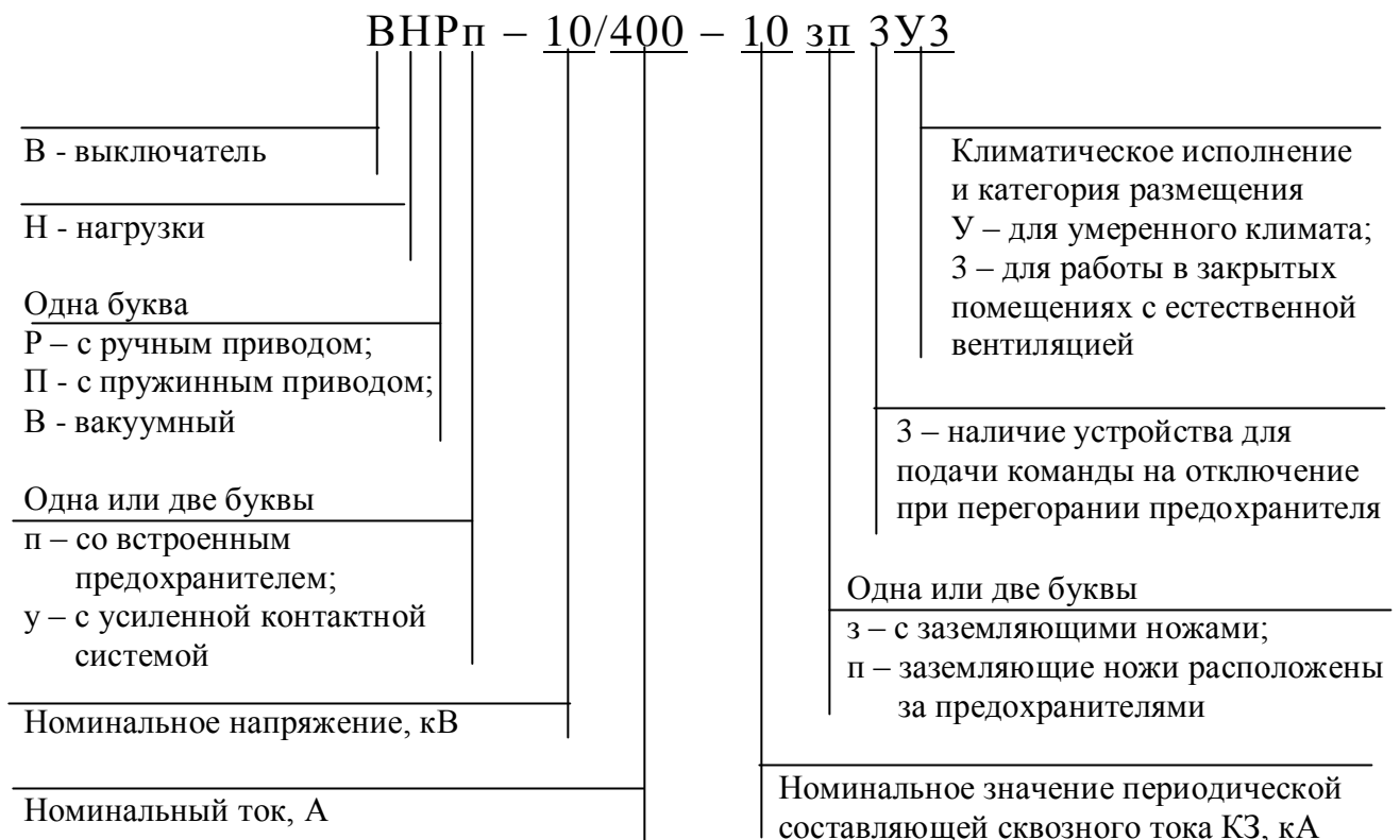
Рис.5.3. Структура условного обозначения выключателей нагрузки
